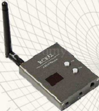
Zum Beispiel dieser RC832 Empfänger. Er verfügt über 32 Empfangskanäle und liefert ein AV Signal zum Anschluss an einen geeigneten Monitor.
